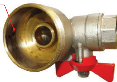
Рис. 2 Отложения солей и шлама в поршневой зоне
