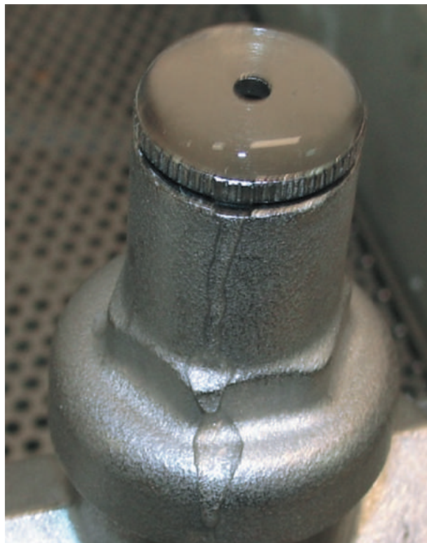
Рис.2 Появление капель воды из пружинной камеры – свидетельство износа поршневых уплотнений
