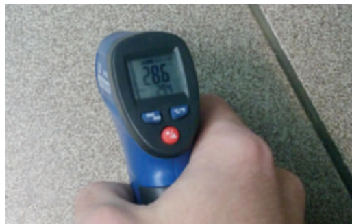
Рис.10 Замер температуры пола пирометром
