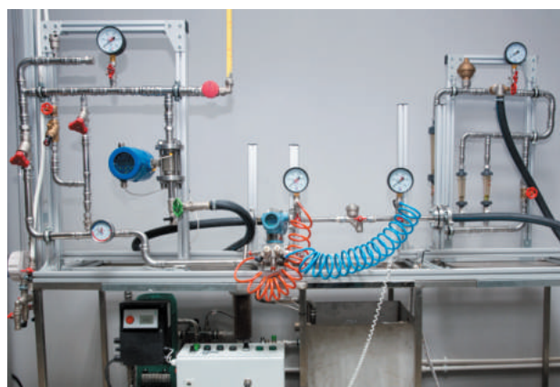
Рис. 14 Стенд гидравлических испытаний лаборатории ЛаКИЭЛИС
