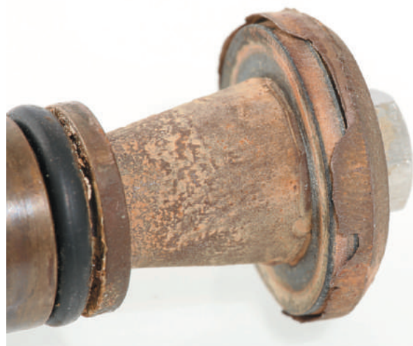
Рис.4 Кавитационное разрушение золотниковой обоймы редуктора
