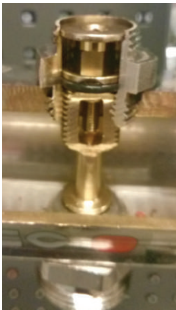
Рис.11 Настрочный клапан полностью закрыт (выше виден настрочный винт)
