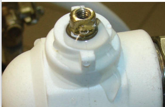
Рис. 2 Протечка шарового крана по штоку.
